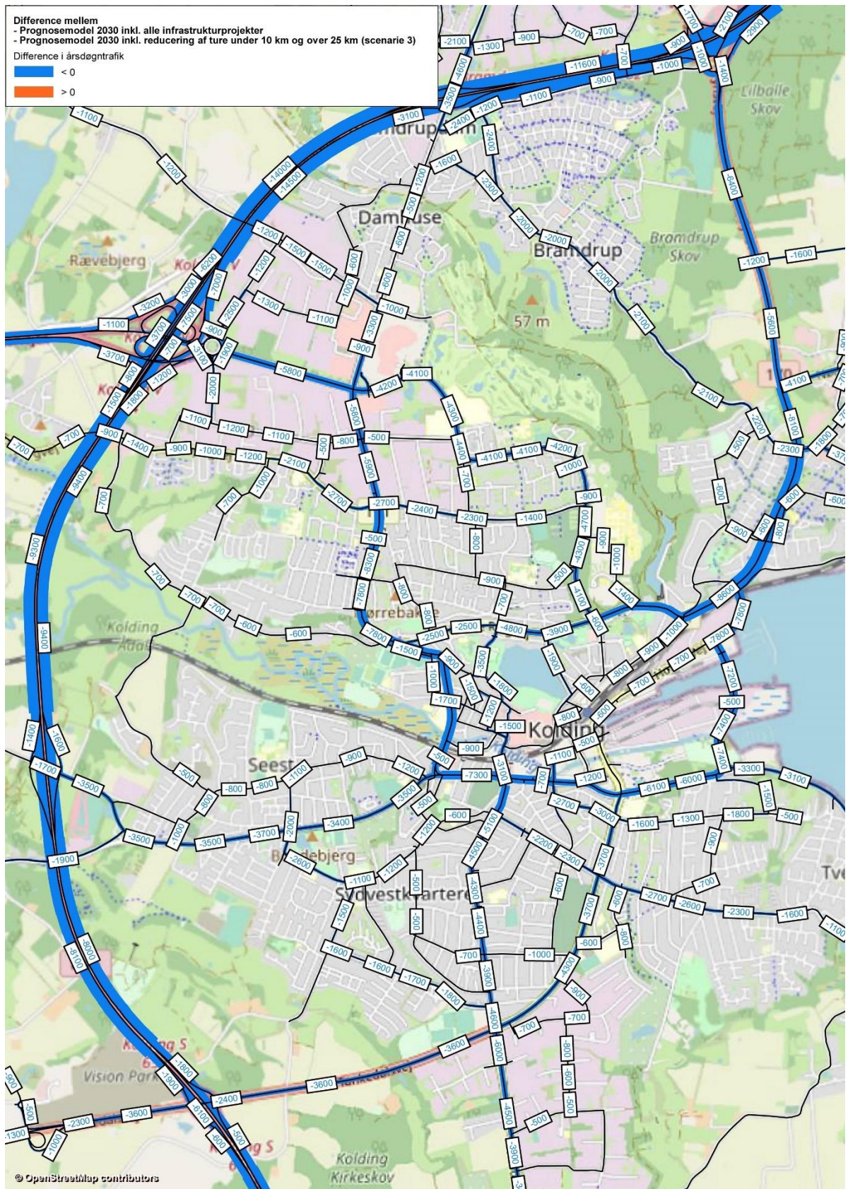
Figur 7.24, Differencekort mellem prognosemodel 2030 inkl. alle infrastrukturprojekter og prognosemodel med reducerings af ture under 10 km og over 25 km for Kolding by.
